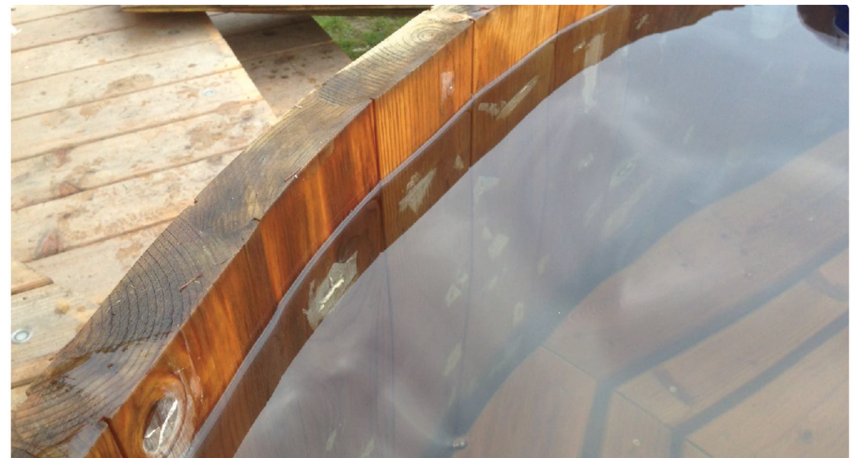
Achten Sie darauf: Auch Thermoholz ist nicht gleich Thermoholz. Abbildung zeigt verklebte Astlöcher eines Badefass.
