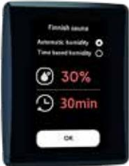
**Der automatische Feuchtigkeitsregelmodus** legt die Solltemperatur im Raum (40–100 °C) und die relative Feuchtigkeit (10–60 % abhängig von der Temperatur) auf konkrete Werte fest. In diesem Modus können Sie die Frequenz oder Wassermenge des automatischen Aufgusses nicht einstellen.
